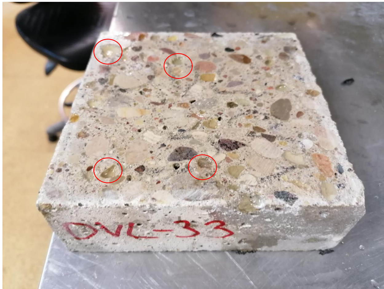
Plātnes testa rezultāti ar oļu pildvielām, nodrupums 150g/m 2
