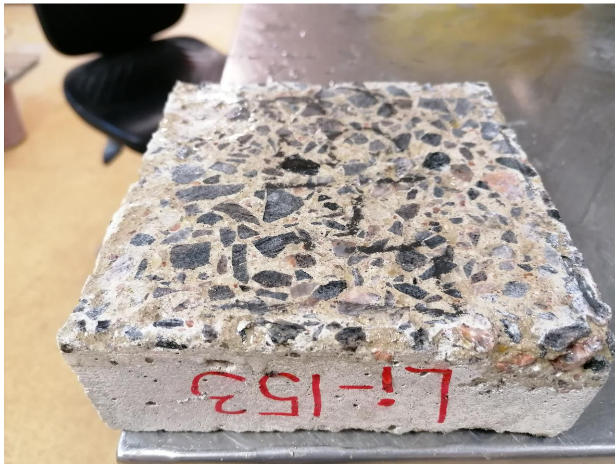
Plātnes testa rezultāti ar granīta pildvielām, nodrupums 190g/m 2
