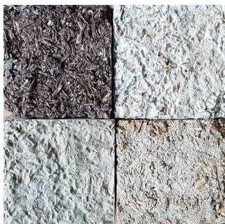
HD biokompozīti no dažādām saistvielām MPC (augšējā kreisajā pusē), BG (augšējā labajā pusē), CSA (apakšējā kreisajā pusē) un MOC (apakšējā labajā pusē).
