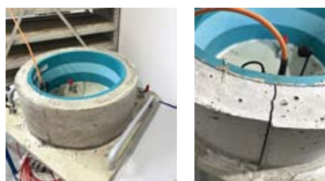
7. un 8. attēls. Tērauda formas relatīvās deformācijas kopš laika, kad reģistrēts žūšanas rukuma sākums. Deformāciju liknes pārtraukums reģistrē betona saplaisāšanas brīdi.
